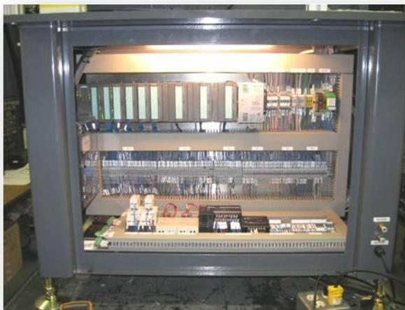
Une interface Windows connectée à un PLC Siemens permet de contrôler tous les paramètres de la machine, de visualiser l'état de tous les capteurs et d'activer chacune des composantes mobiles pour en faciliter l'entretien. La disposition des puces dans les trays était localisée dans une base de données centralisée partagée entre plusieurs machines.
